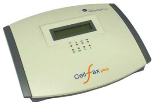
A través del CELL-FAX los usuarios podrán disfrutar de comunicaciones de voz de alta calidad usando codecs EFR ("Enhanced Full Rate") y comunicaciones de datos de hasta 85,6kbps usando GPRS para e-mails y acceso a Internet. GPRS Class 10 (3rx + 2tx) y GPRS Class 10 (4rx + 2tx).
